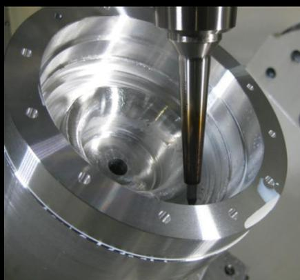
高精度同時5軸加工
