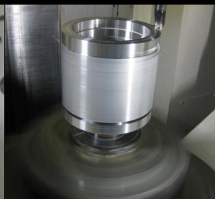
高精度複合軸旋削加工
