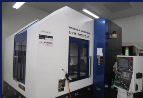
東芝機械 UVM-700 (5AD) * 超精密5軸微細加工機
