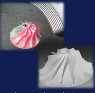
レーザースキャン測定による精度保証 (Mitutoyo SurfaceMeasure606)
