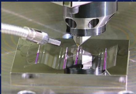
直線軸 3 軸(X,Y,Z)と回転軸 3 軸(A,B,C)
