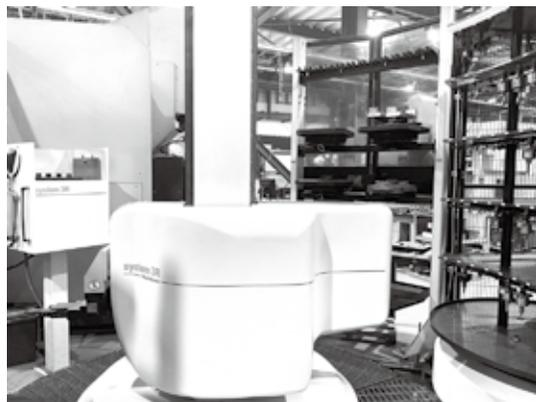
図2 自動化ロボット WorkMaster と放電加工セル
